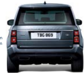
Ancho de vía trasero 1.685 mm
